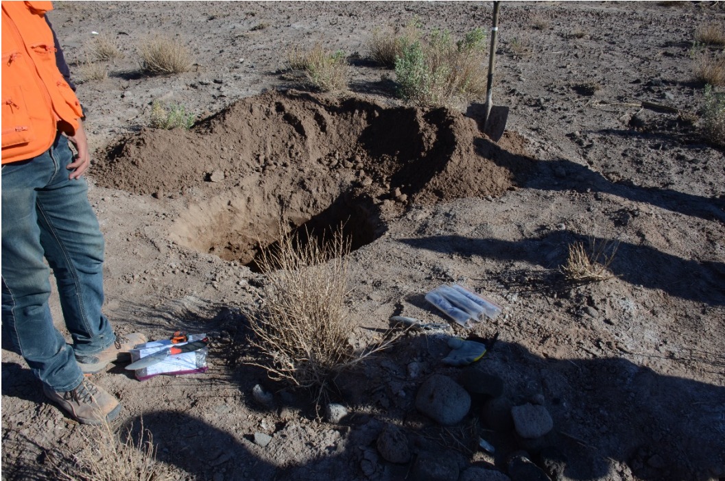
Fotografía 6: Excavación de calicata para obtención de muestra de suelo (24 de abril de 2019).
